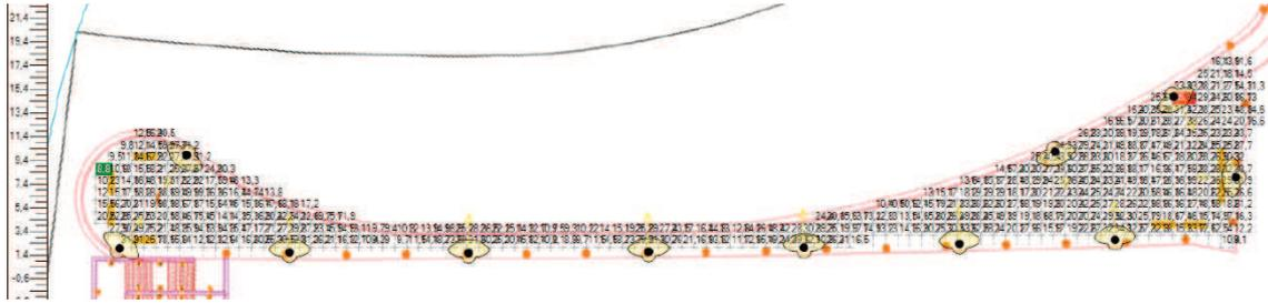
**Situación 15:** Se trata de iluminar una zona de escaleras situada en el sector P, Q y O. Para ello se emplea la luminaria modelo Kazu 500mA 5068 de 25,7 W de potencia colocada a una altura de 4 metros.
