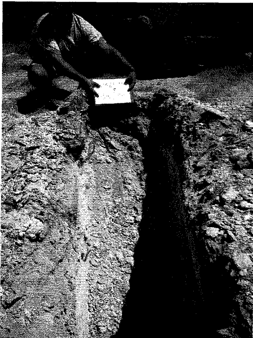
Perfil y material recuperado en la realización de la calicata C-8
