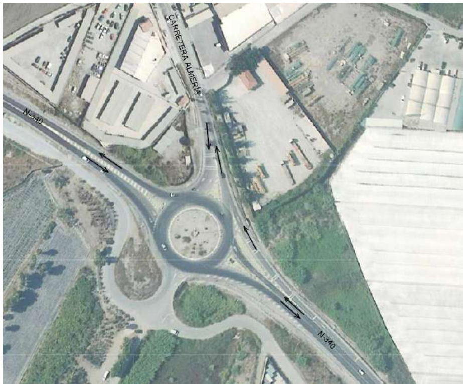
Figura 21. Flujos de tráfico actual en intersección entre N-340 y Carretera de Almería
