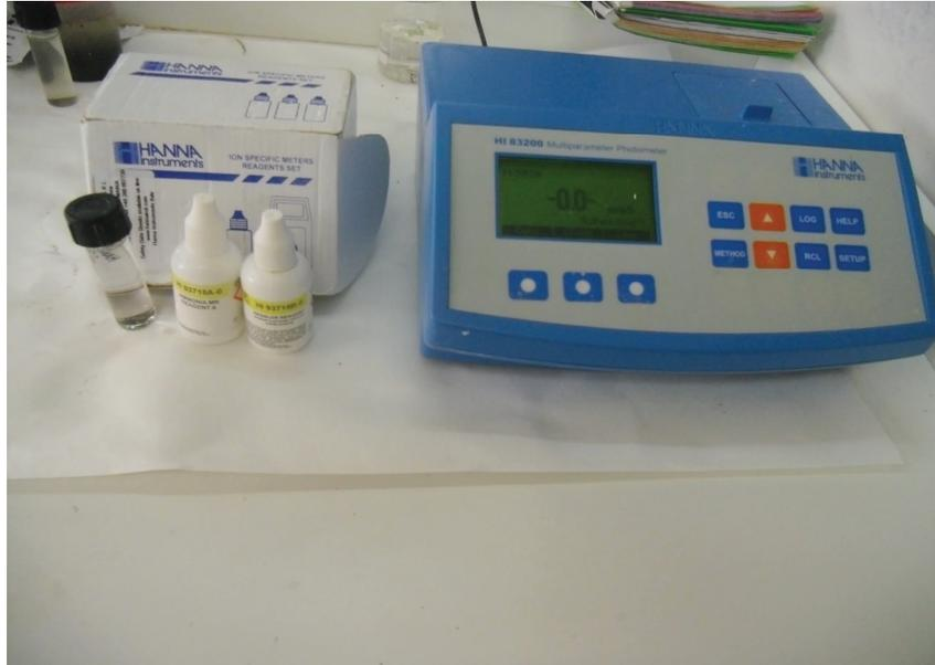
5. Se pulsa TIMER y el display mostrará la cuenta atrás previa a la medición que será de 3 minutos y 30 segundos. Cuando la cuenta atrás finalice, el instrumento realizará la lectura. El instrumento muestra los resultados en mg/l de nitrógeno amoniacal (NH<sub>3</sub>-N).
